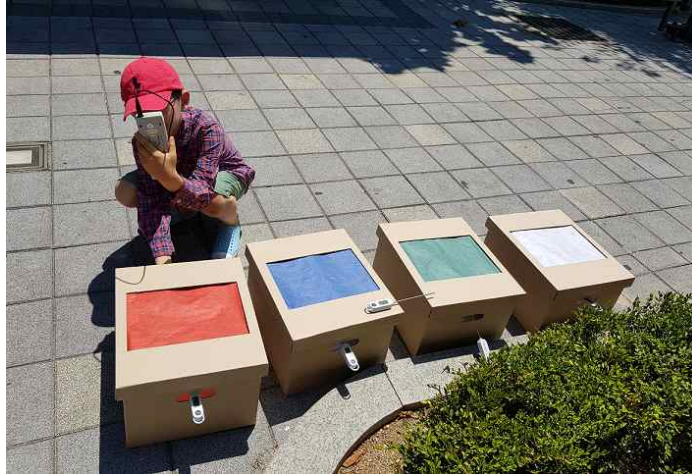
< 한지의 자외선 차단효과와 열 차단 효과를 알아보기 위한 측정 모습 >
